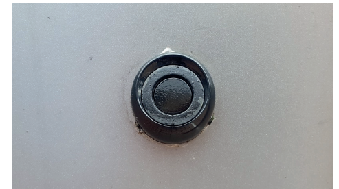
Montage affleurant d'un ensemble capteur/manchon sur une surface verticale.
